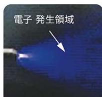
プラズマ放電の一種である「ストリーマ放電」から発生する高速電子は、空気中の酸素や窒素と合体することで、強力な酸化分解力をもった活性種に変化し、カビやダニ（フン・死骸）、花粉などのアレル物質や有害化学物質を除去します。一般的なプラズマ放電（グロー放電）と比べて、同じ電力を投入したときの酸化分解速度は 1000 倍以上。その分解力は、およそ 100,000℃\*の熱エネルギーに匹敵します。
