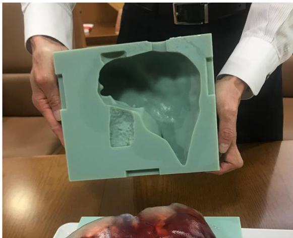
3D プリント樹脂型「デジタルモールド」で成形した肝臓のモデル。植物由来の材料でできており、型と3Dプリンタで造形された血管を用いて繰り返し作製することができる。
