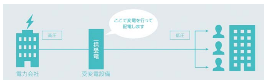
【高圧一括受電システム】
