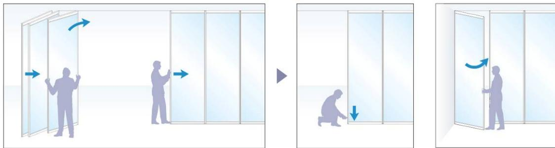
格納部からパネルを順次引き出してレールに沿って移動させます。パネル下部にキャスターがついているため操作はスムーズに行えます。
