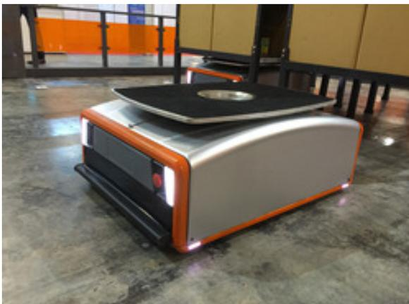
GROUND: 自動搬送ロボット「Butler (バトラー)システム」
