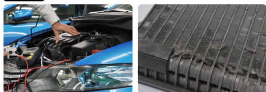
高圧洗浄機 エバポレーターなど内部の汚れを確認しながら洗浄
