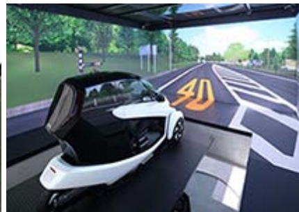
▲名古屋大学に納入した大型 4K5 面立体視ドライビングシミュレータ
