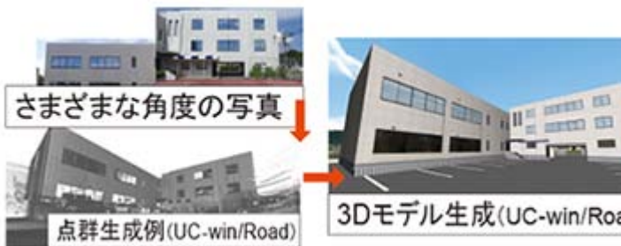
▲SfM 写真解析・点群・自動 3D モデル生成
