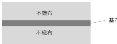
イメージ図: 中間基布(断面中央)で施工時の寸法安定性を向上
