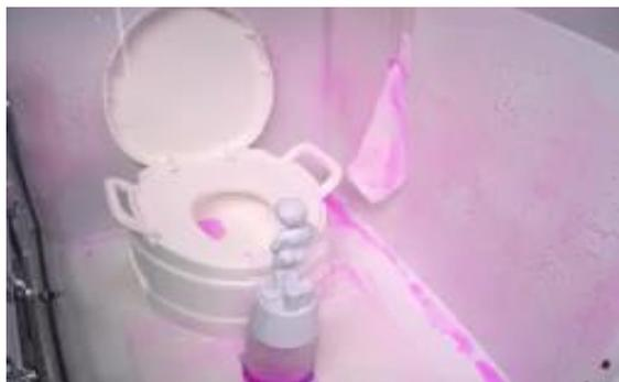
密閉空間で検証実験の様子。トイレを使用するとアンモニア（ピンク色）が空気中に蒸発し、浸透性のある壁に吸着される。
