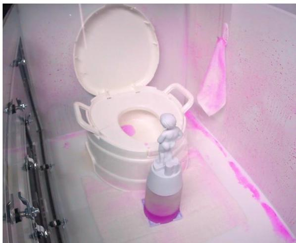
密閉空間で検証実験の様子。トイレを使用するとアンモニア（ピンク色）が空気中に蒸発し、浸透性のある壁に吸着される。
