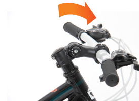
■アジャスタブル(可変式)ステム 乗車する環境やライダーに応じて、ハンドル角の設定が可能(プラス40度からマイナス40度)です。
