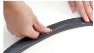
②空気漏れの穴の位置を確認し、付属の紙やすりでこすります。
