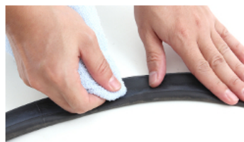
③穴周辺をウエス(乾いた布)で拭き汚れ、ゴミ、水分を取り除きます。
