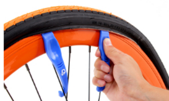
①付属のタイヤレバーを使用し、チューブを外します。
