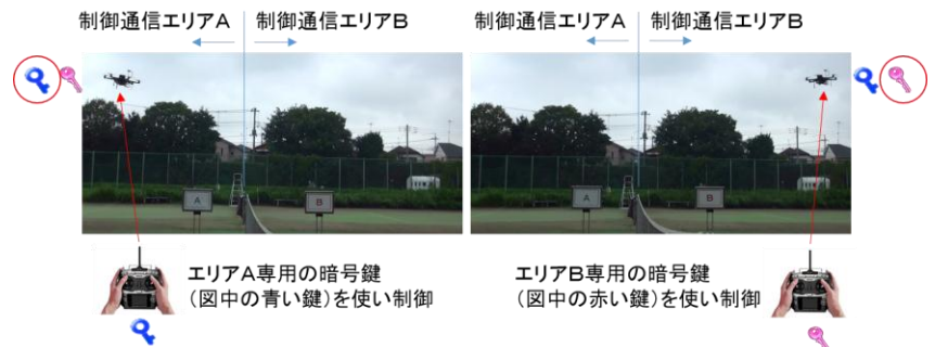
図 3 異なる飛行制御エリア間での暗号化制御通信の引継ぎ
