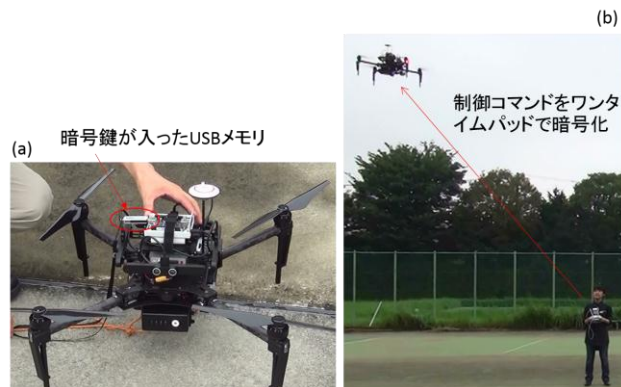
図 1 暗号鍵（真性乱数）の供給と ワンタイムパッド暗号化による飛行制御
