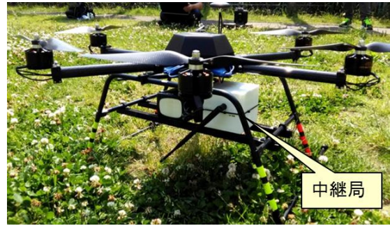
図4 中継局を搭載したドローン (ミニ・サーベイヤー(※7))
