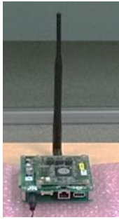
図3 試作開発した無線装置 (制御局・中継局・被制御局共通仕様、バッテリー駆動)
