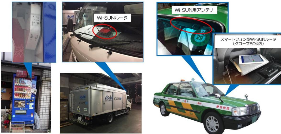
図 5 Wi-SUN ビーコン発信機設置自動販売機(左)、Wi-SUN ルータ搭載飲料補充車両(中央)及びスマートフォン型 Wi-SUN ルータ搭載タクシー(右)
