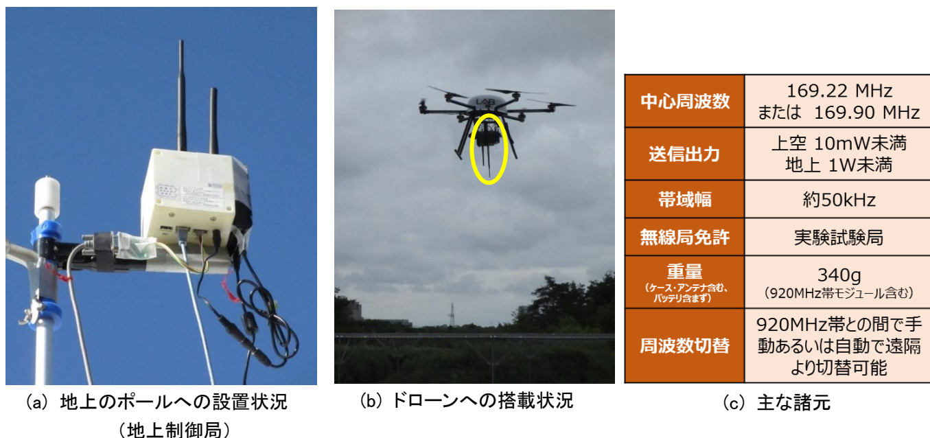
図 1 920MHz 帯と 169MHz 帯のハイブリット無線装置の試作機とその主な諸元 (長い方のアンテナが 920MHz 帯、短い方が 169MHz 帯)
