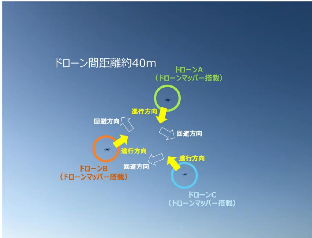
図2 飛行制御試験時の様子(3機のドローンによるニアミス回避飛行の場合) (2018年12月18日、埼玉県秩父市)
