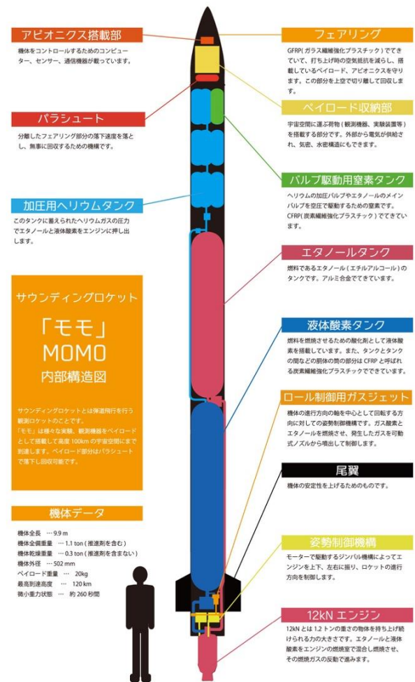
図 2: サウンディングロケット「モモ」MOMO 内部構造図 ( http://www.istellartech.com/technology/momo )
