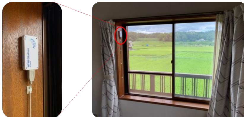
図5 すれ違いIoT無線ルータを木造家屋2階の窓際に設置した様子
