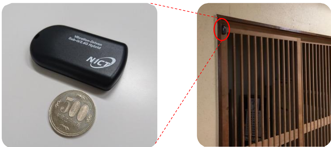
図 3 別途開発したドア開閉センサ機能付き Wi-SUN ビーコン発信機 (通称: つぶやきセンサ) 設置の様子
