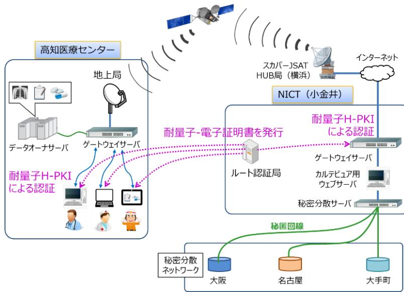
図3 耐量子一公開鍵認証基盤によるアクセス管理システム概要
