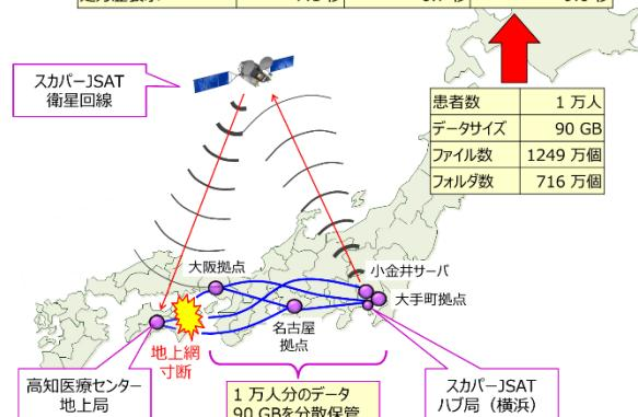
図1 実証実験に用いたネットワーク接続図と性能評価結果
