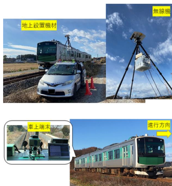
図1 実証実験での無線機設置の様子（上：地上、下：車上）
