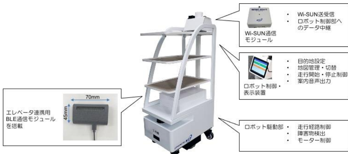
図 2 実証実験で用いた自律移動型ロボットの外観・機器構成
