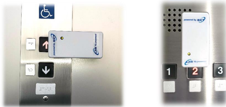
図 1 IoT ボタン押下デバイス WiWi-Finger 設置の様子(左: エレベーター外、右: エレベーター内)
