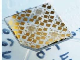
酸化ガリウムトランジスタを作製したチップ
