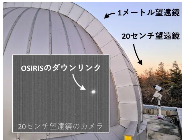
図4 OSIRISv1 からダウンリンク光を受信した 1m 望遠鏡と 20cm 望遠鏡(簡易型光地上局)
