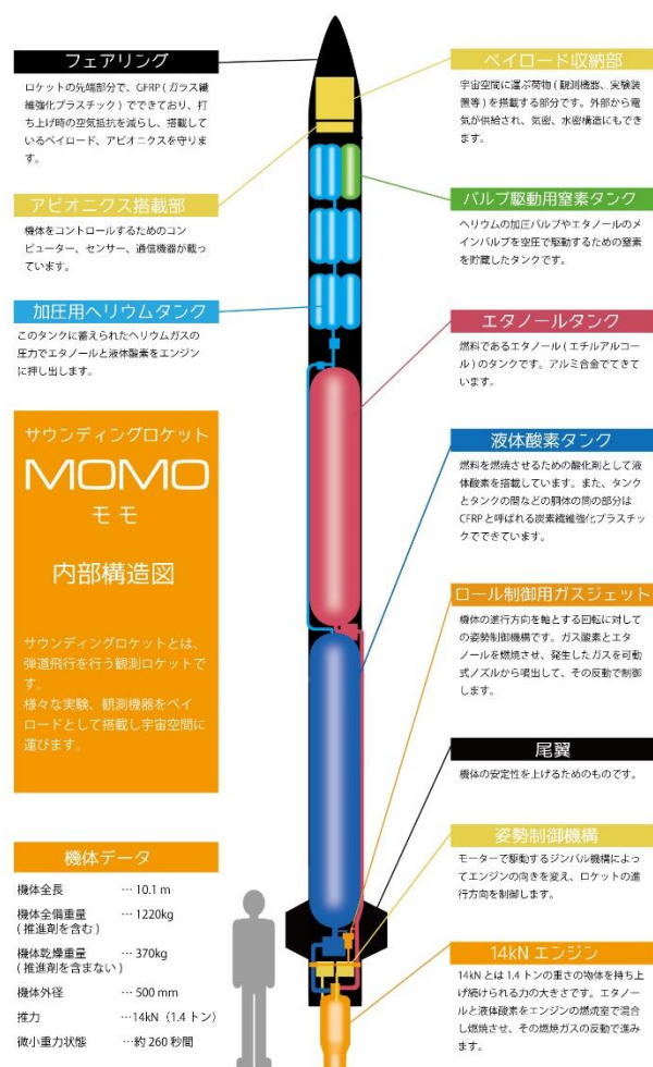
図 2 サウンディングロケット「MOMO」MOMOv1 内部構造図
