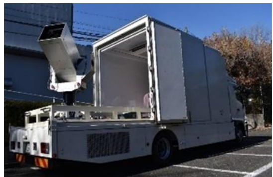
図 3 今回開発した可搬型光地上局と直径 35 cm 望遠鏡の外観
