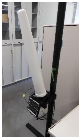
図 3 定点測定用の測定装置の例
