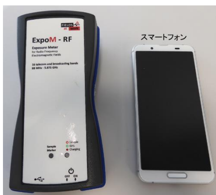
図 5 携帯型測定器(左)とスマートフォン(右)の例
