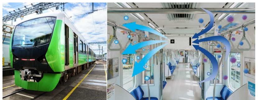
図1 今回開発した高強度深紫外 LED 空気殺菌モジュールを搭載した鉄道車両
