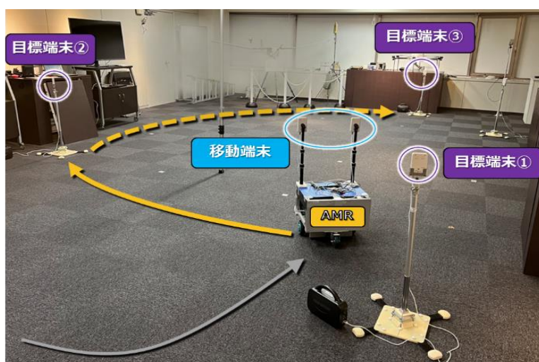
図 1 AMR 動作検証実験の様子
