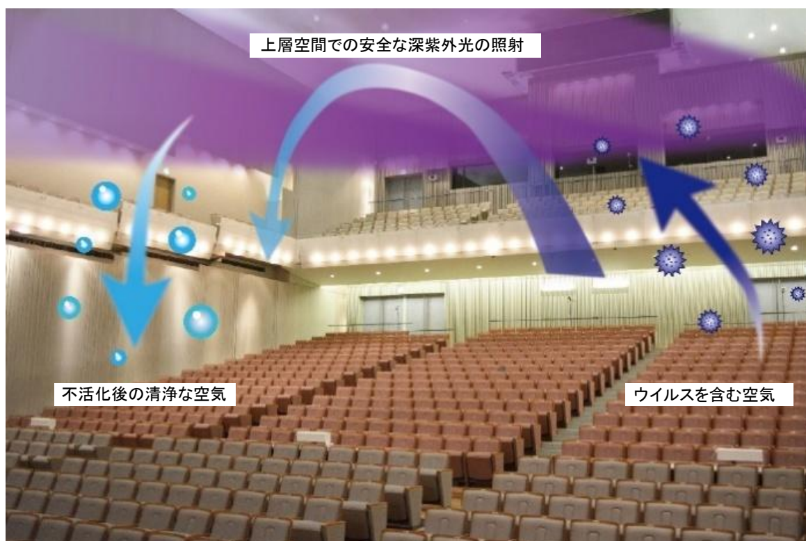
図5 今回開発した深紫外 LED 大空間殺菌システムを設置した 公共大型ホール(熊谷文化創造館さくらめいと 太陽のホール)の写真と配置
