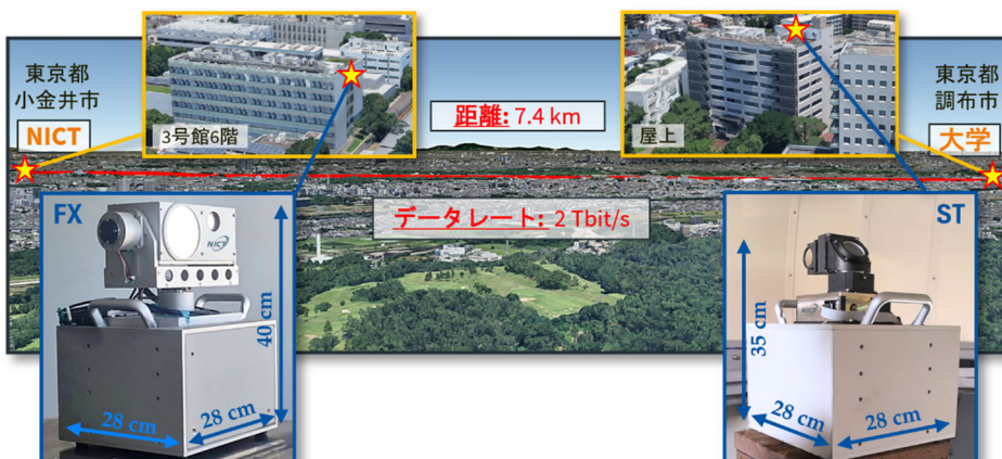
図 1 NICT の 7.4 km、2 Tbit/s 水平空間光通信実験（2025 年 4 月）。ST 端末を送信側、FX 端末を受信側として使用。また実験では回線品質を評価するための疑似ランダム信号（PRBS）を伝送。2 Tbit/s の伝送速度は毎秒約 10 本のフルサイズ 4K UHD 映画を送るのに相当。
