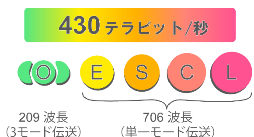
図 1 本実証で用いた波長帯（3 モード伝送の O 帯と単一モード伝送の E, S, C, L 帯）
