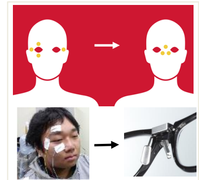
(図 2) 三点式眼電位センサーの開発によりアイウェアへの応用が可能に
