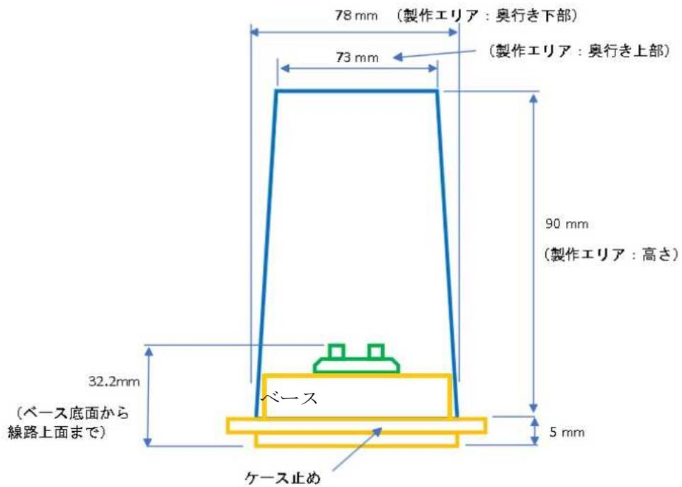
ベース下面からレール上面の高さは 32 mm~33 mmの間に制作してください。
