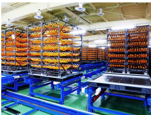
2階乾燥室、“動く干場”での自然乾燥の様子（オートメーションで連吊り台車が動き、あんぽ柿の環境差を少なくするようにしています）
