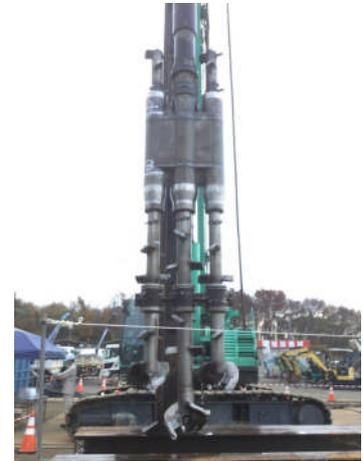
写真-2 固化工程専用機先端部
