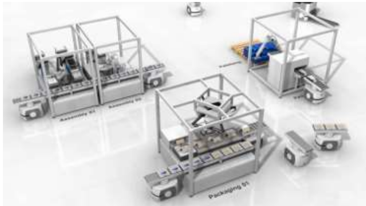
生産品目に応じて構成変更するフレキシブルな生産ライン
