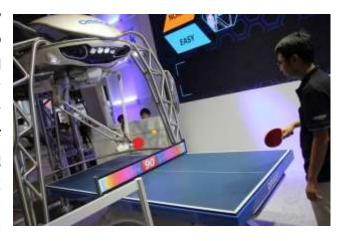
結果を基にしてラリーの最中に相手の競技レベルを上級者/中級者/初心者から瞬時に判別。相手のレベルに合わせた返球速度や返球位置の調整を、返球精度±5cmという高精度で行うことで、互いの成長を図ることが期待できます。
