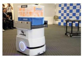
「モバイルロボット LD」は、独自の人工知能(AI)技術を搭載し、自動車や電子部品、食品・医療品などのモノづくりの現場をはじめ、研究施設、物流倉庫など様々な屋内空間において、人や障害物を自動で回避しながら最適なルートを自ら考え、決められた場所に荷物を届けるのが特長です。従来の自動運転ロボットは、床に掛かれたラインなどを読み取りながら自動運転を行うのが一般的ですが、「モバイルロボット LD」は内蔵するレーザースキャナーで動作環境を測定し、移動可能な範囲の地図を自動的に作製。地図とレーザースキャナーの測定結
