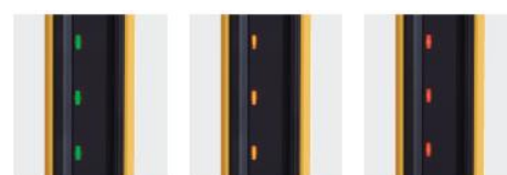
安定入光状態 緑：制御出力ON状態 光量低下状態 橙：制御出力ON状態 遮光状態 赤：制御出力OFF状態 (エリアビームインジケータ)
