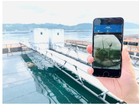
生けす上に設置されたスマート給餌機 魚の食欲に応じて、適宜、給餌する
