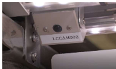
⑤レーンに取り付けたカメラで、取られたお皿を自動的にカウントするセルフチェック (コンタクトレス)
