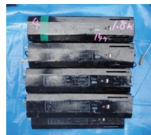
業務用・施設用蛍光灯の安定器
