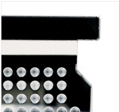
写真 4. くびれ構造部分の拡大
