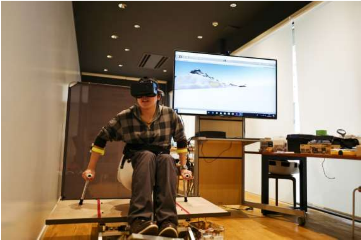
VR 画像上の斜面と連動して台座が動き、より臨場感が味わえる
