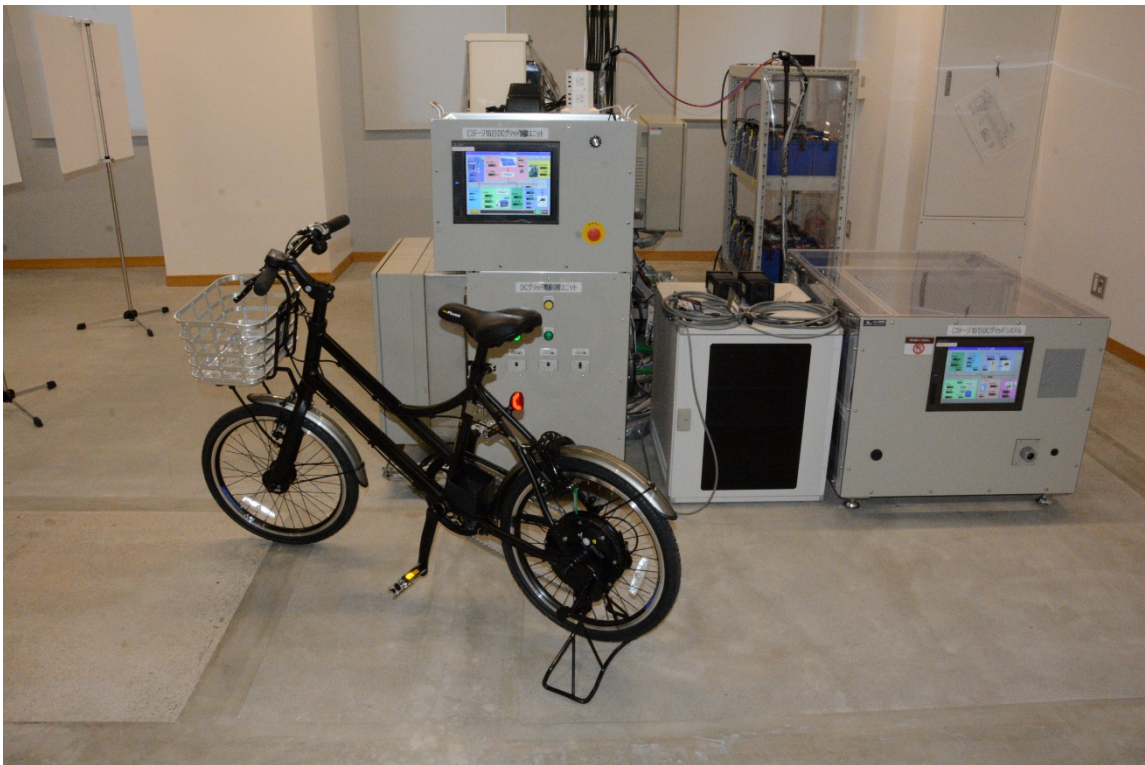
人力により直流発電(回生)が可能な電動自転車を新たに導入し、直流電力網に接続。 1 時間漕いで 100Wh の電力量が得られる
