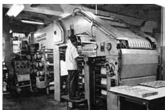
ドイツ製のジオリ4P凹版輪転印刷機（凹版ザンメル印刷）とその構造図
