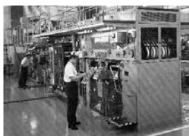
印刷局が開発したドライオフセット凹版輪転印刷機
