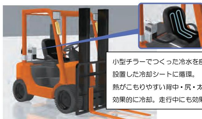
小型チャラーでつくった冷水を座席に設置した冷却シートに循環。熱がこもりやすい背中・尻・太もも裏を効果的に冷却。走行中にも効果を発揮。
