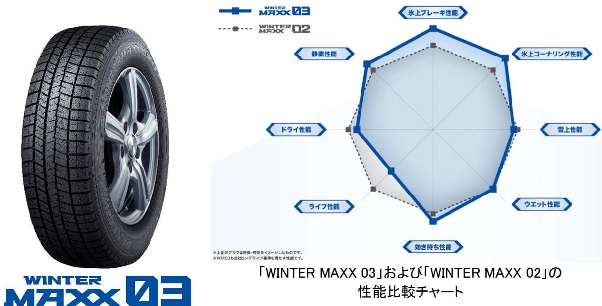
「WINTER MAXX 03」は、『ナノ凹凸ゴム』の凹凸構造の微細な突起部分がいち早く水膜に到達することで除水スピードが速まり密着時間が増加するとともに、素材の柔らかさにより氷への密着を高めることで、新品時の氷上ブレーキ性能が22%向上<sup>\*1</sup>し、氷上コーナリング性能も11%向上<sup>\*2</sup>しました。
