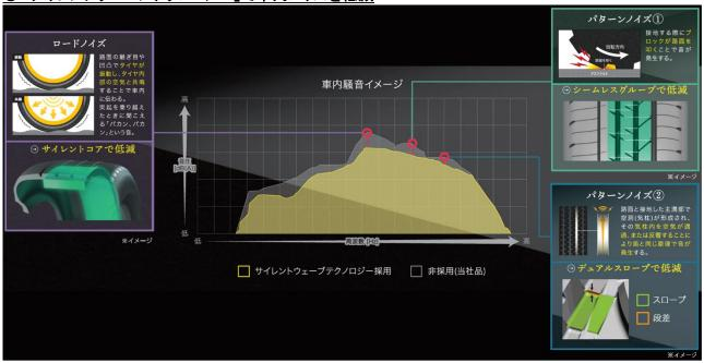
ドライバーの耳につく音である周波数帯の音圧を抑え、周波数の波形をなだらかにしてノイズを低減する、最新の「サイレントウェーブテクノロジー」を採用。タイヤ表面のパターンをブロックと溝が途切れない様に接地する「シームレスグルーブ」デザインにすることで、接地面のブロックが路面を叩くことで発生するパターンノイズを低減します。また主溝内部にスロープを配置する「デュアルスロープ」によって、タイヤ溝内の
