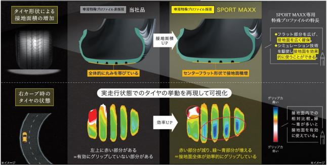
SPORT MAXX 専用特殊プロファイル「マックス・ドライバビリティ・テクノロジー」搭載によって、広くなった接地面で路面を捉えることが可能になり、操縦安定性能が向上します。同プロファイル非採用品と比べ、カーブ走行時により小さな舵角で思い通りの走行が可能になります。
