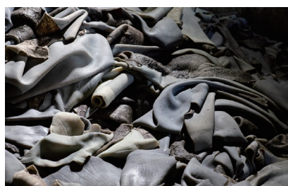
図版 3. アルカリ処理をした牛皮 撮影地：埼玉県草加市・河合産業
